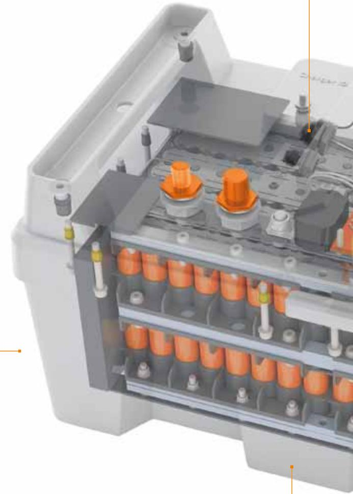
**Boîtier étanche IP67 :** même si de manière générale, il vaut mieux éviter d'immerger la batterie, toutes les batteries Torqeedo sont entièrement étanches et supportent une immersion à 1 m de profondeur pendant au moins 30 minutes sans subir de dommage, conformément à la norme IP 67. L'étanchéité de chaque batterie est contrôlée avant la livraison !
